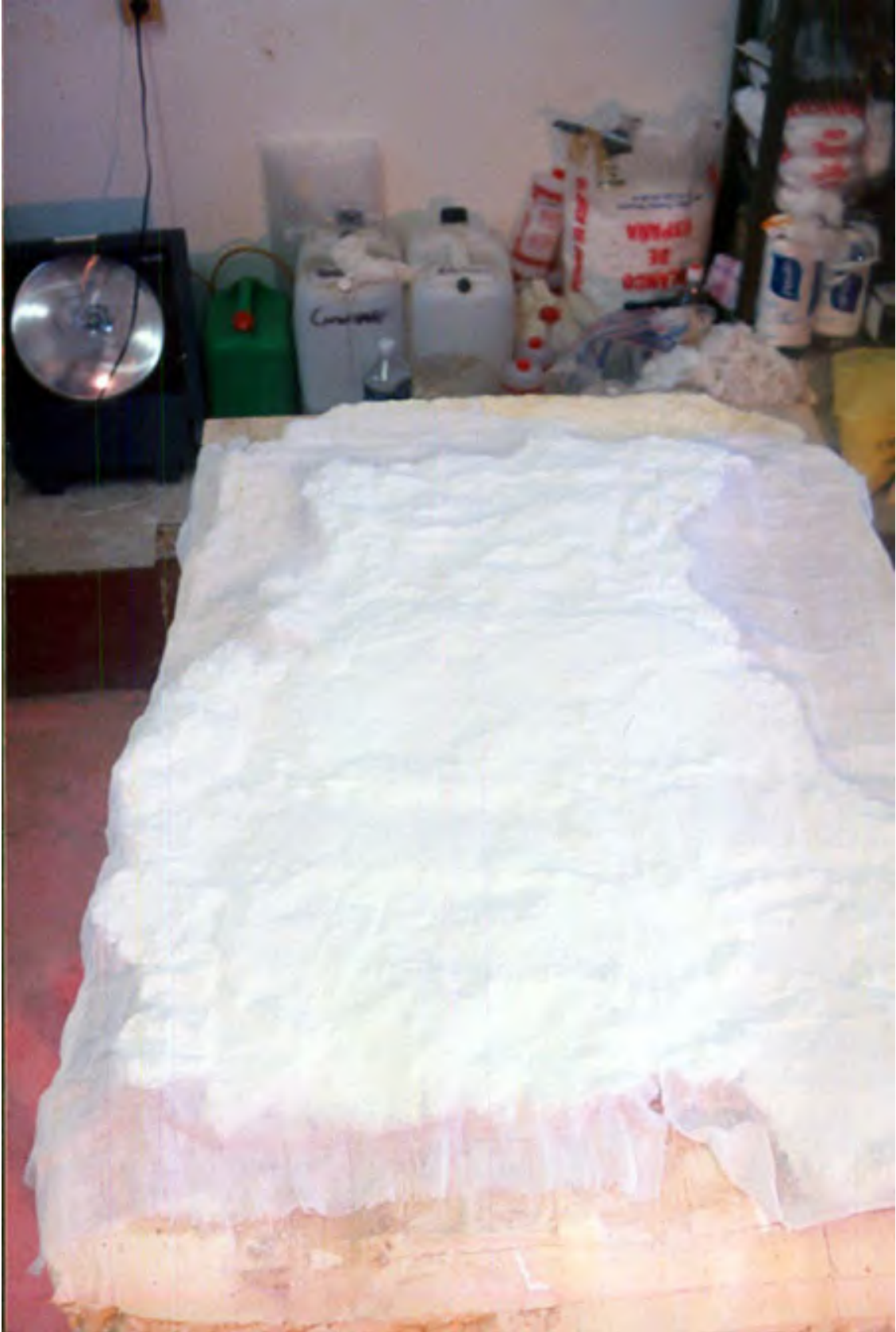
Foto 26. Capa aislante de manta de cielo y caseinato de calcio
