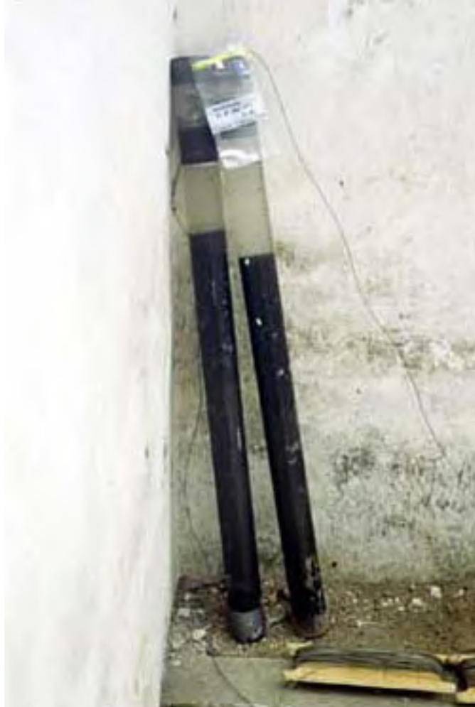
Figura 4b: Sacanúcleos utilizado por Brenner & Curtis para extraer muestras del Lago Amatitlán.
